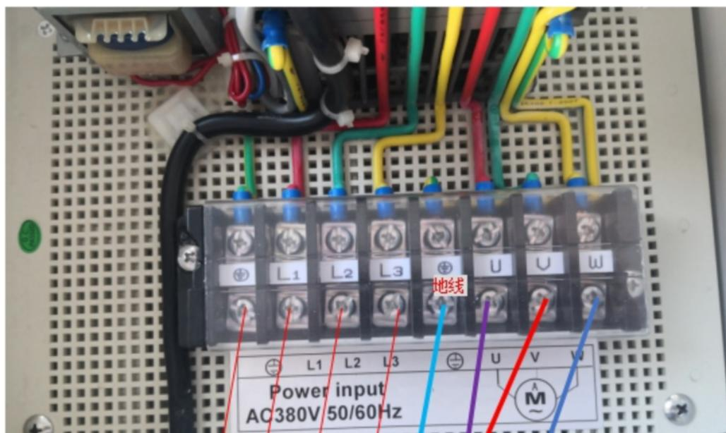
Raccordement en triphasé : sur L1, L2 L3 ( attention au sens de rotation.
